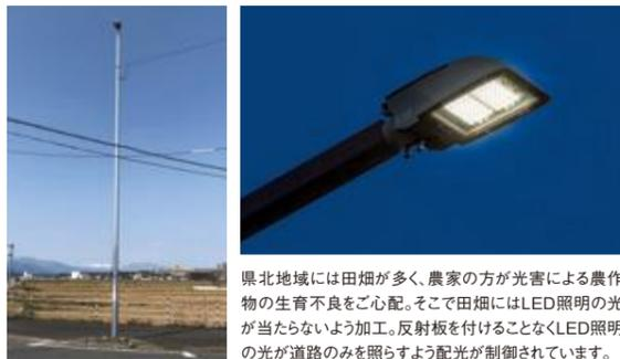
県北地域には田畑が多く、農家の方が光害による農作物の生育不良をご心配。そこで田畑にはLED照明の光が当たらないよう加工。反射板を付けることなくLED照明の光が道路のみを照らすよう配光が制御されています。
